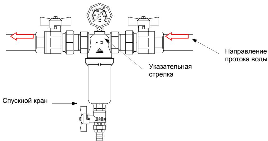
Схема показывает, как установить самоочищающийся фильтр в системе водоснабжения. Устанавливать самоочищающийся фильтр следует вентилем спуска **вниз**, чтобы взвешенные частицы скапливались на его дне. Указательная стрелка на корпусе фильтра показывает направление протока жидкости.
