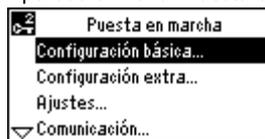
4. Seleccionar el submenú "Configuración básica...". Seleccionar el tipo de instalación/tipo básico y la posición de los módulos de opción.
