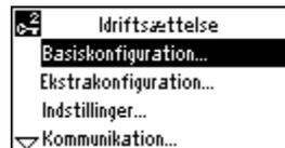
4. Vælg undermenuen "Basiskonfigurering". Vælg anlægstype/basistype og position for optionsmodulene.
