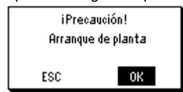
10. Pulsar el cursor navegador para aceptar con OK. Arrancará la aplicación, se verificarán todas las sondas, y las sondas utilizadas se sobreiluminarán para mensajes de error que puedan requerirse posteriormente. Aparece el menú principal:
