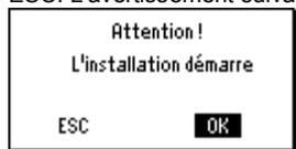
10. Appuyez sur le bouton de navigation pour confirmer (OK). L'application démarre, toutes les sondes sont vérifiées, les sondes utilisées sont sélectionnées pour les éventuels messages d'erreur ultérieurs. Le menu principal apparaît :
